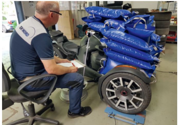
▲ Aufwändig: Zubehörteile welche die "Stammdaten" des Fahrzeugs verändern würden, müssen sorgfältig geprüft und getestet werden.
