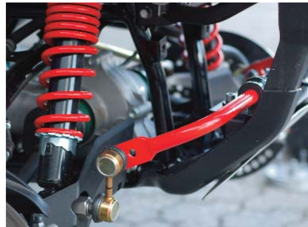
Fahrwerke: Stoßdämpfer und Stabis etwa müssen eine hohe Qualität aufweisen und werden demnach besonders in Augenschein genommen.
