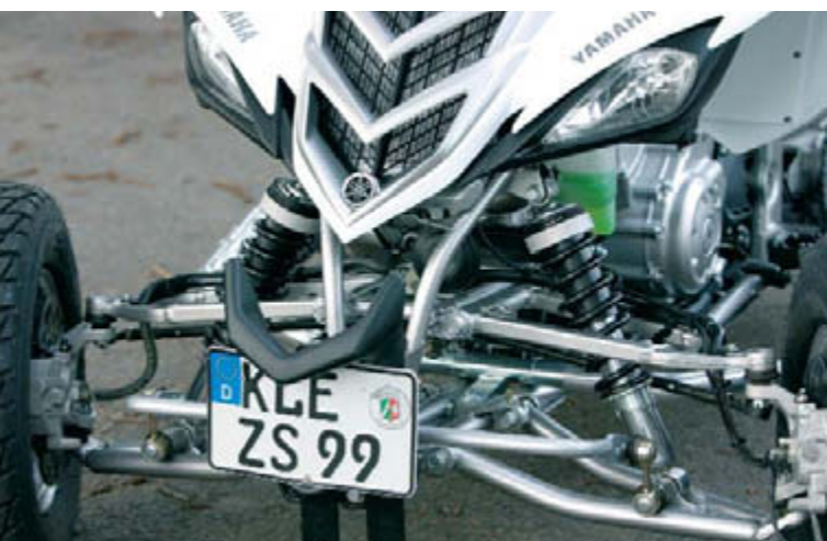
Gelenkig: Edle Teile aus Alu und V2A sparen Gewicht.
