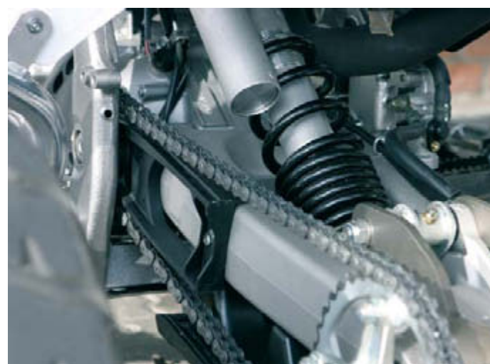
Hinten: Auch der hintere Dämpfer erhielt neue Federn.
